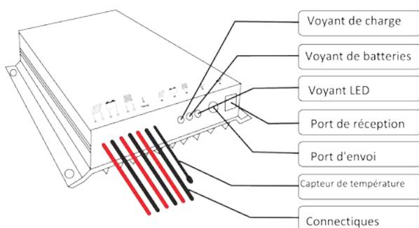
le *Solario* est équipé d'un contrôleur intelligent (en option avec télécommande) réalisant les fonctions de charge/décharge des batteries, incluant toutes les sécurités, ainsi que toutes les fonctions d'éclairage, soit à partir d'une horloge astronomique et d'une programmation simple, soit par détection du coucher et du lever du soleil et/ou des séquences de temps. Ils sont incorporés dans le pied du mât avec fermeture sécurisée
